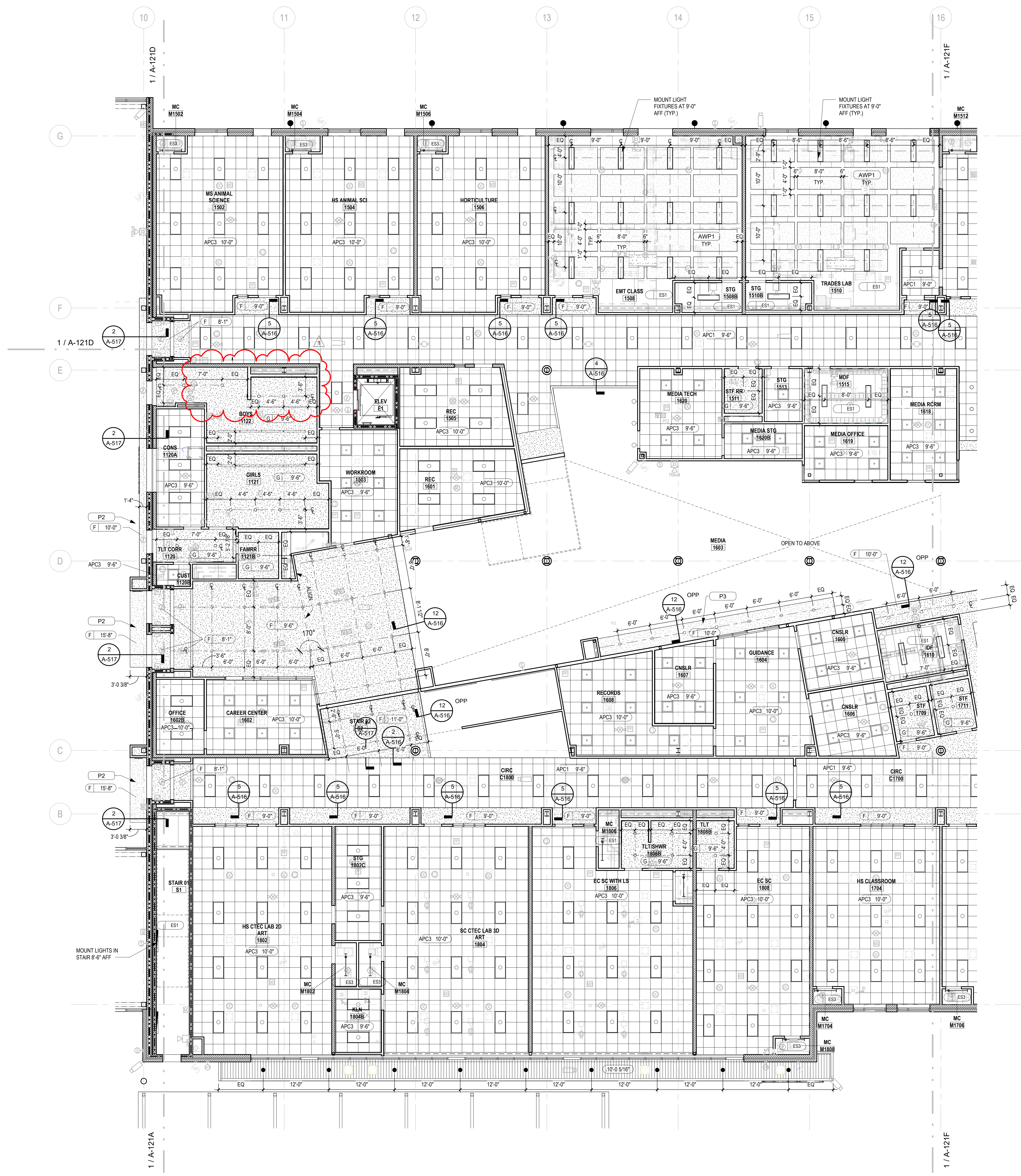
1 FIRST FLOOR RCP AREA E SCALE: 1/8" = 1'-0"
